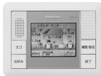
エネルギーモニター
